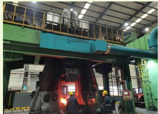
▲ 鍛造二部 16T 鍛錘主機配置兩套除塵系統
