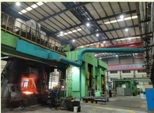
▲ 鍛造二部 16T 鍛錘主機配置兩套除塵系統
